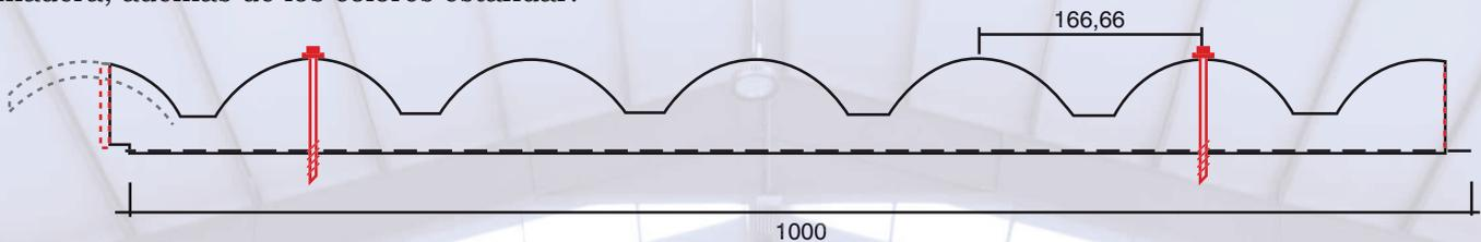
**NOTA IMPORTANTE:** Para una correcta instalación es importante realizar la fijación de los tornillos en la posición donde se indica en la figura superior. Para una óptima instalación, se recomienda una separación entre apoyos no mayor a 1 m.
